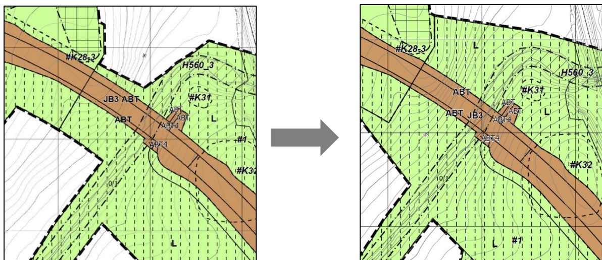
Figur 3-24: Grunnstabilisering ved jernbanebru over sidebakk til Kråkstadelva. Til venstre ; offentlig ettersyn høsten 2025. Til høyre ; tilleggshøring.
