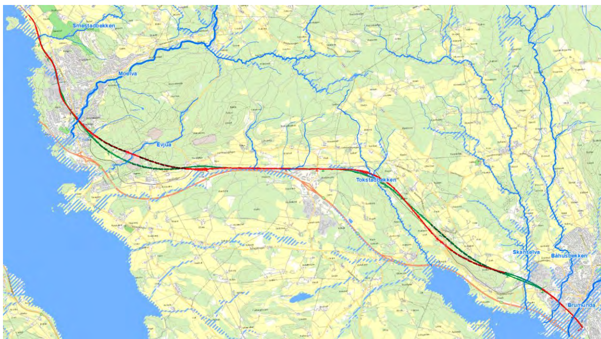
Figur 55 Planlagt jernbanestrekning Brumunddal – Moelv. Alternativ A (Rød) og Alternativ B (Grønn). Hovedvassdrag som krysser planlagt linje sammen med NVEs flomaktsomhetskart (Stripet blå).
