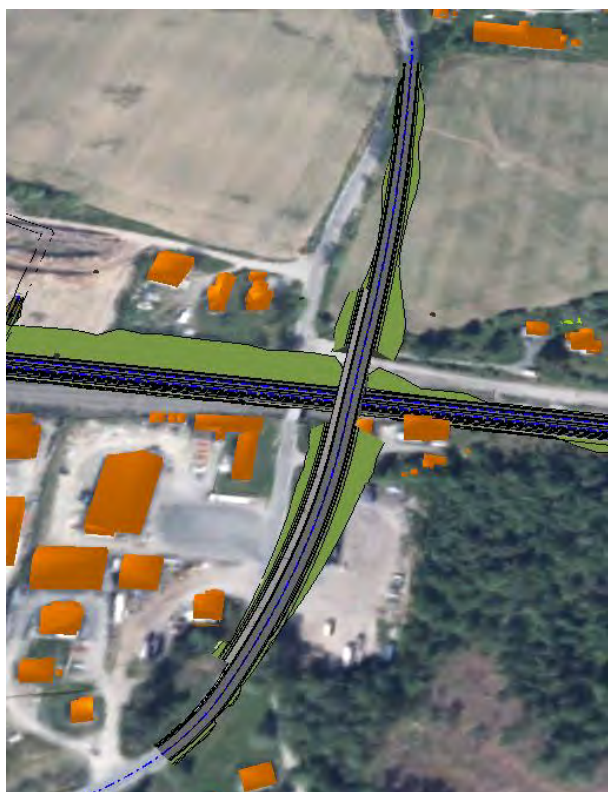
Figur 33: Ny bru for Rudsvegen over nytt dobbeltspor
