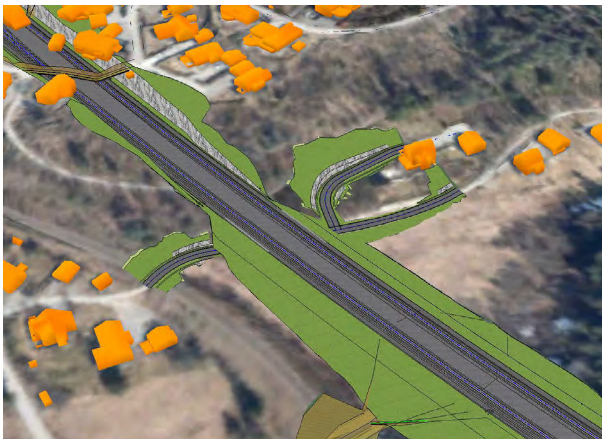
Figur 37: Oversiktsbilde Ekredalsvegens forlengelse under spor
