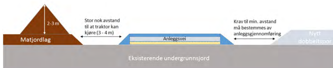
Figur 7-3 Prinsskisse for mellomlagring av jord langs anleggsbelte.
