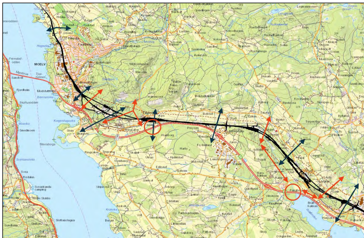
Figur 6-2: Vilttrekk (hovedsakelig elg og rådyr) på tvers av jernbanetraséen. Svarte piler angir kjente vilttrekk i området (kilde: Finn Sønstebj i Ringsaker kommune i e-post 23.2.2022). Røde sirkler er plassering av viltunderganger langs ny E6, mens røde piler viser hvor det vil være mulig for større viltarter å krysse ny jernbane samt hvordan trekket kan gå videre for å passere under (Botsenden og Ulvegutua) eller over E6 (Skarpsnotunnelen).
