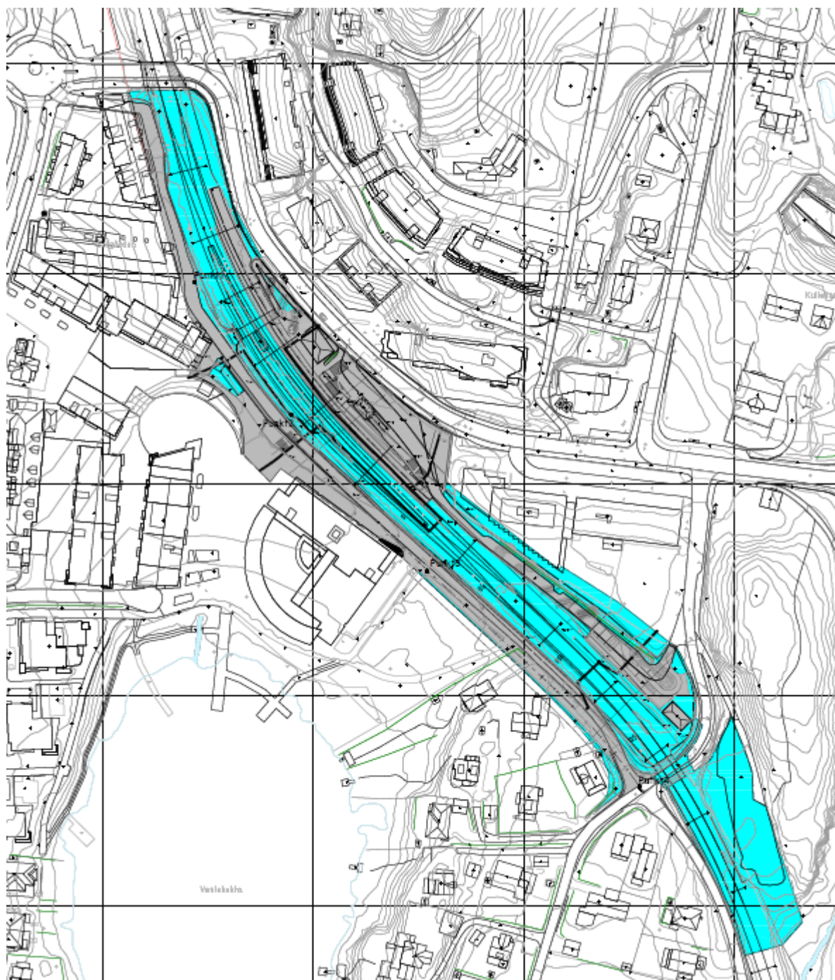
Figur 17: Tegningen viser eksisterende situasjon. Turkis viser antatte permeable overflater (grus og grønne områder) og grå områder er harde overflater (asfalt, betong og hustak).
