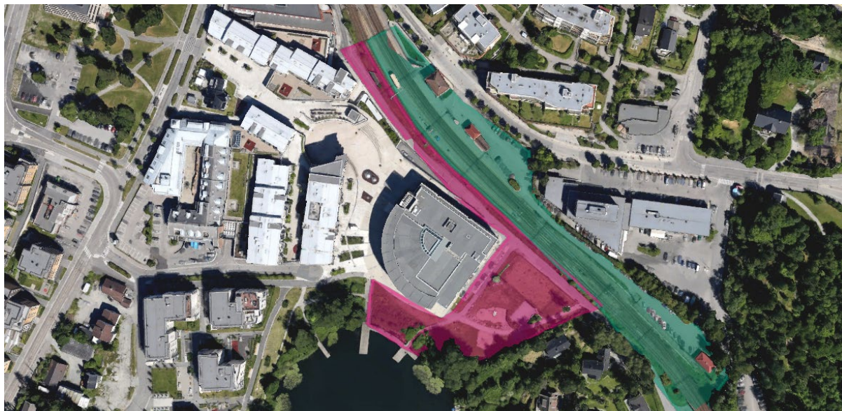
Figur 1 Omtrentlig skille mellom fast (grønn) og bløt grunn (rød)
