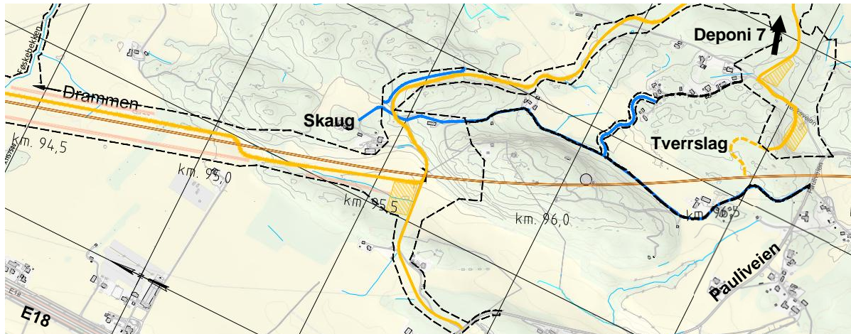
Figur 2-4: Anleggsadkomst for dagsonen Sletterødåsen - Skaug. Anleggsvei videre til deponi D7 og riggområde og tverrslag for tunneldriving
