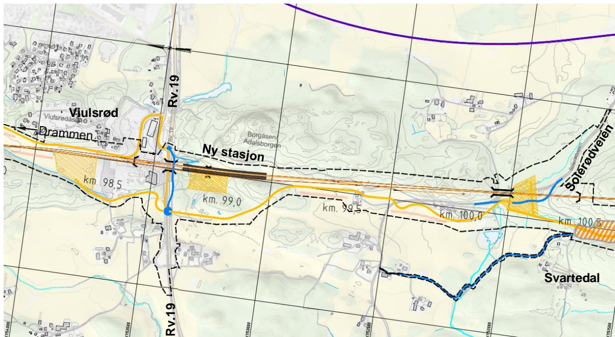
Figur 2-5: Anleggsadkomst for arbeider på Viulsrød og Solerødveien
