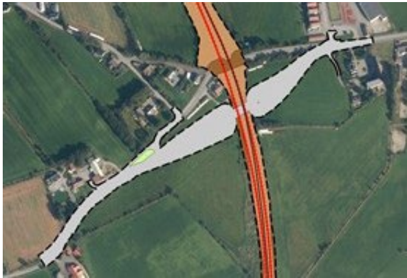
Figur 25. Ved Hognestad må en ny og lengre bru for FV215 etableres over dobbeltsporet. For å sikre vegtilkomst under anleggsfasen blir gammel bru erstattet av en ny bru 75 meter sør for dagens bru.
