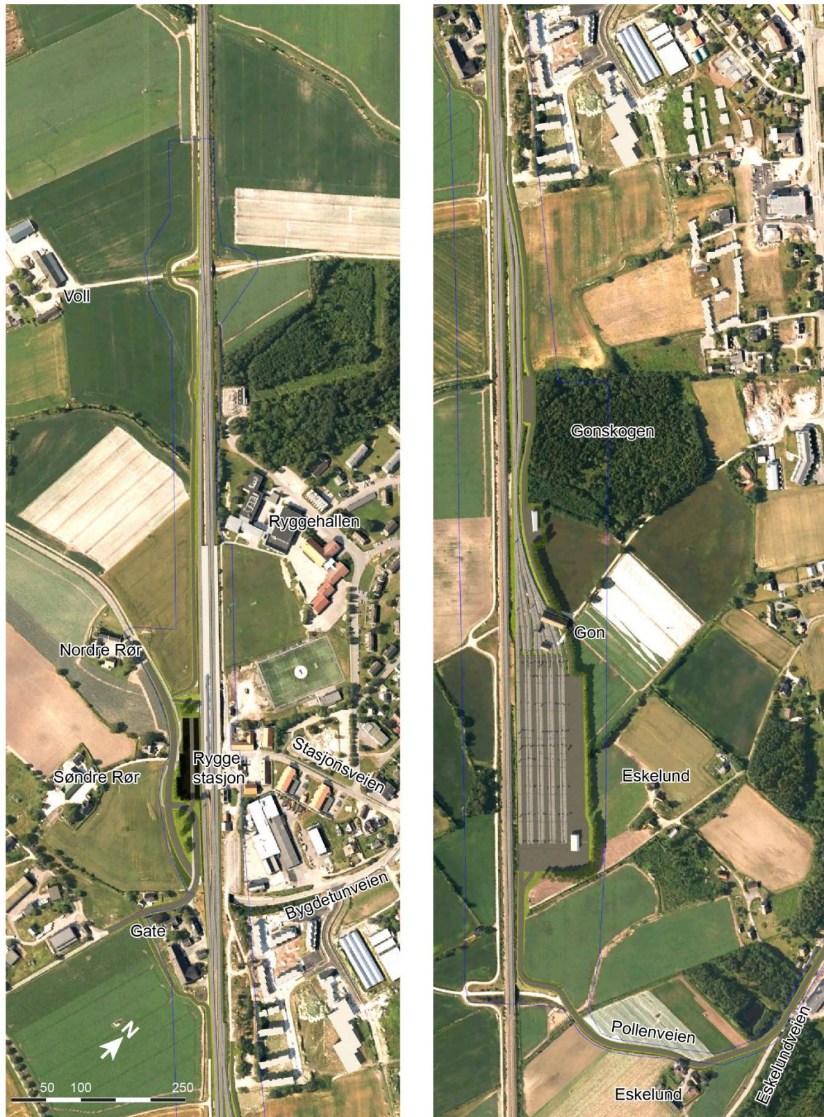
Figur 6: Mulig omfang/løsning for hensettingsanlegg ved Gon, hentet fra prosjektets samordningsmodell. Fordi planområdet er langstrakt er illustrasjonen delt, den nordligste delen av området til venstre.
