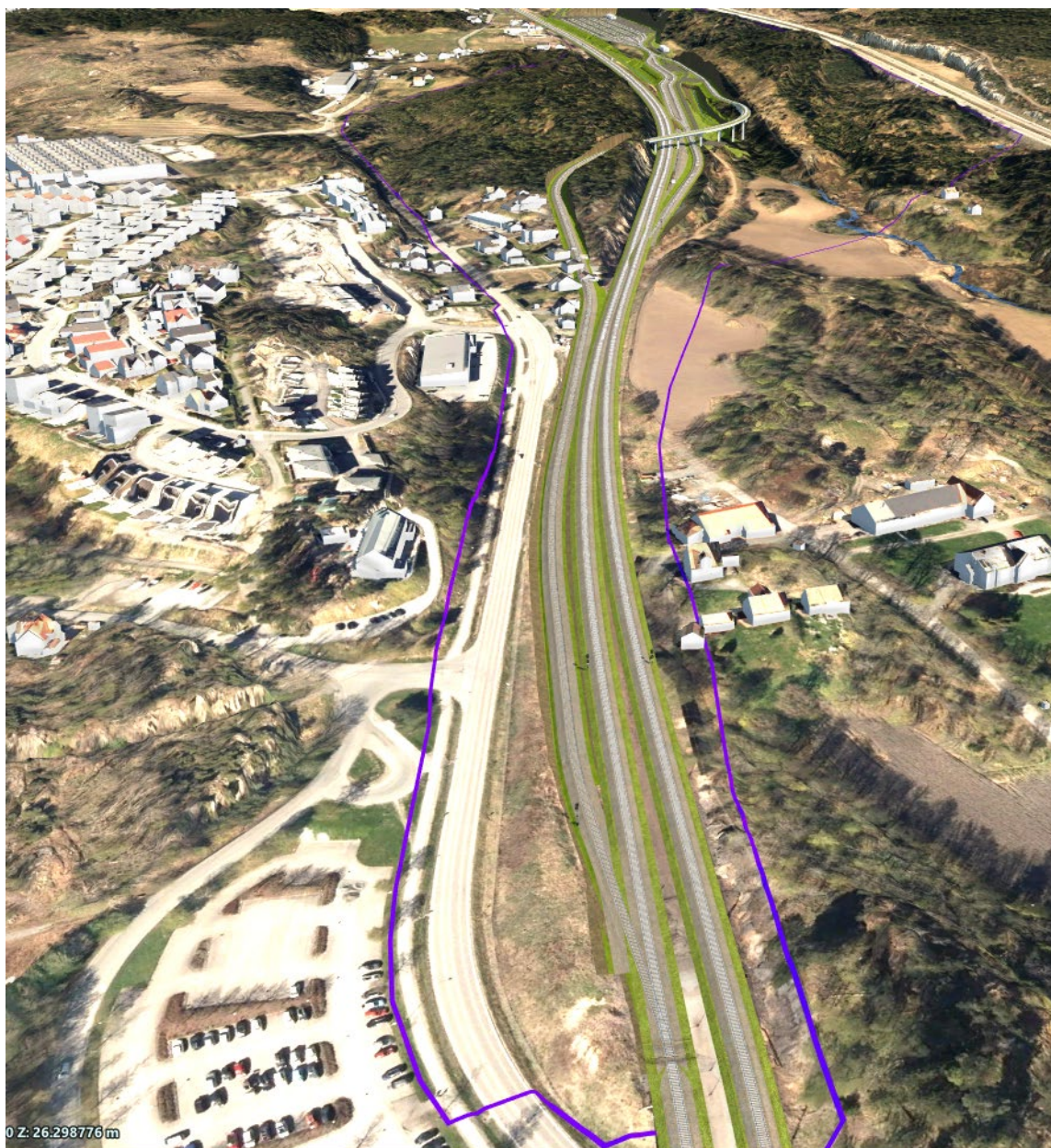
Figur 10 Oversiktsbilde over ankomstområdet til hensettingsanlegget sett fra sør. Bru over eksisterende spor vises sentralt i bildet. Påkjøringssporet vil gå i tosidig skjæring på deler av strekningen, eksisterende boliger må innløses og rives
