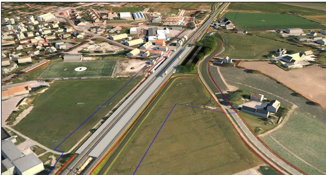
Figur 13 Oversiktsbilde fra nordvest. Rygge stasjon utvides til tre spor. Midtstilt ventespør gjennom stasjonen kan også benyttes som stasjonsspor
