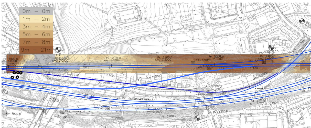
Figur 3-17: Oversikt over løsmassedybder langs Hovedbanen.
