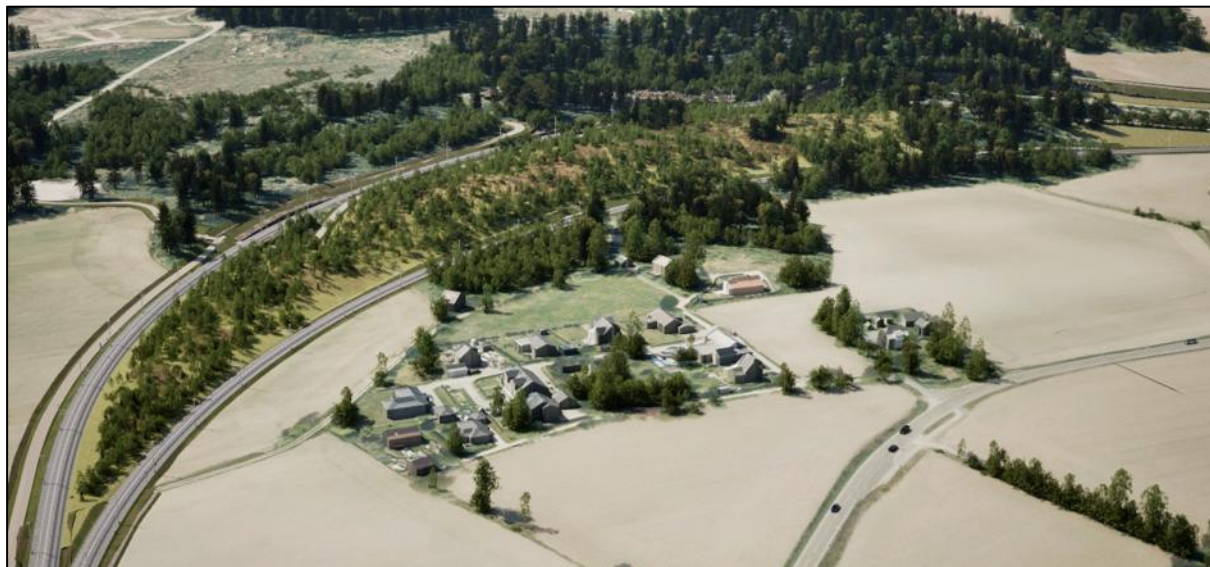
Figur 6-12: Område for planlagt masselager mellom nye jernbanespor på Kjølstadhøgda. Illustrasjon sett i fugleperspektiv mot vest. Boligområdet Kjølstadhaugen ses i forgrunnen. Nytt terreng på masselageret utformes som små koller, og det reetableres skog som tilpasning til omgivelsene rundt.
