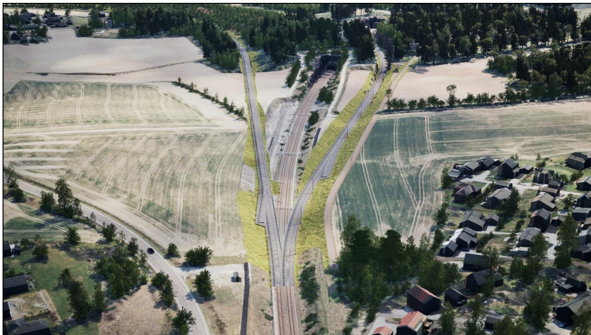
Figur 6-4: Oversiktsillustrasjon/fugleperspektiv, sett mot sør (i retning fra Ski). Ny avgrening Østre linje skiller lag med Vestre linje i et sørgående spor (til høyre i illustrasjonen) og et nordgående spor (til venstre i illustrasjonen). Sørgående spor krysser Vestre linje planskilt og kommer sammen med det nordgående sporet like vest for Åsveien, hvor de to sporene samles til et dobbeltspor i retning østover. Bebyggelse i Follogrenda/Folloveien ses nederst til høyre.
