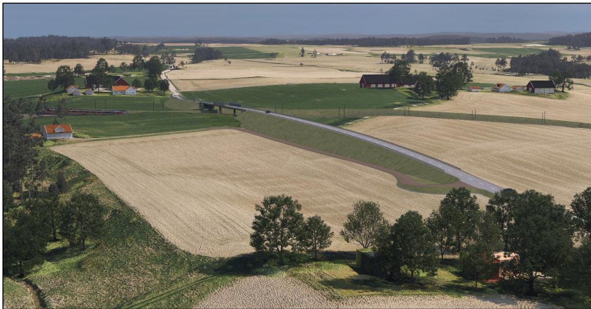
Figur 6-9: Alternativ L0 - Illustrasjon av tiltaket, sett i fugleperspektiv mot nord. Ny avgrensning Østre linje krysser under Løkenveien (fv. 1370), som heves i forhold til terrenget i bru over jernbanen. Atkomsten til Vang gård (i øvre høyre del av illustrasjonen) legges om til nordsiden av ny jernbane. Atkomsten til Løkenveien 30, på sørsiden av jernbanen, legges om.
