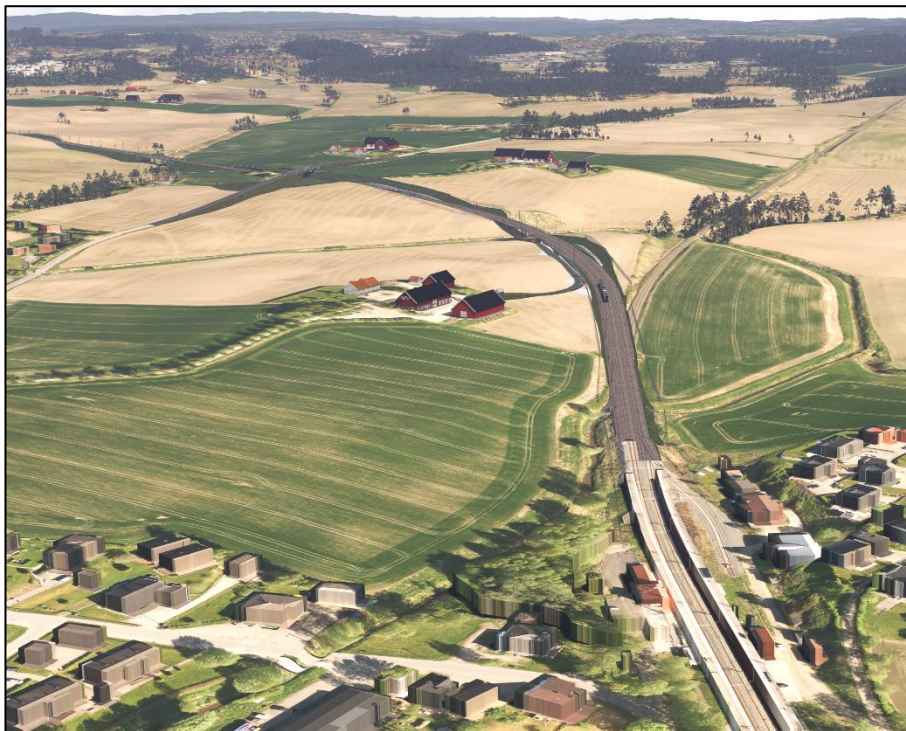
Figur 6-11: Oversiktsillustrasjon av tiltaket (alternativ L0), sett i fugleperspektiv fra Kråkstad-området og mot nord. Cirka 250 m nord for Kråkstad stasjon (nederst til høyre) møter ny avgrening for Østre linje dagens Østre linje, som kan ses til høyre i illustrasjonen. I øvre del av illustrasjonen ses veibrua for Løkenveien (fv. 1370), og jernbanebrua over Engsbekken og sidebekken til Kråkstadelva.
