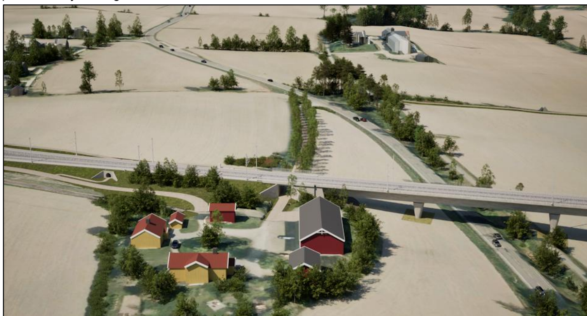
Figur 6-39: Illustrasjon ved Nordre Kjølstad gård, sett mot nord. Det planlegges turveiatkomst i undergang under jernbanen, som kan ses i venstre del av illustrasjonen. Undergang med kjøreatkomst til Nordre Kjølstad gård ses i midtre del av figuren. Planlagt turvei fra Åsveien og videre mot øst kan skimtes i øvre høyre del av illustrasjonen.
