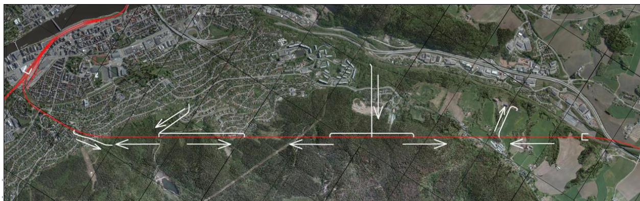
Figur 19: Driveretning for bygging av jernbanetunnelen.
