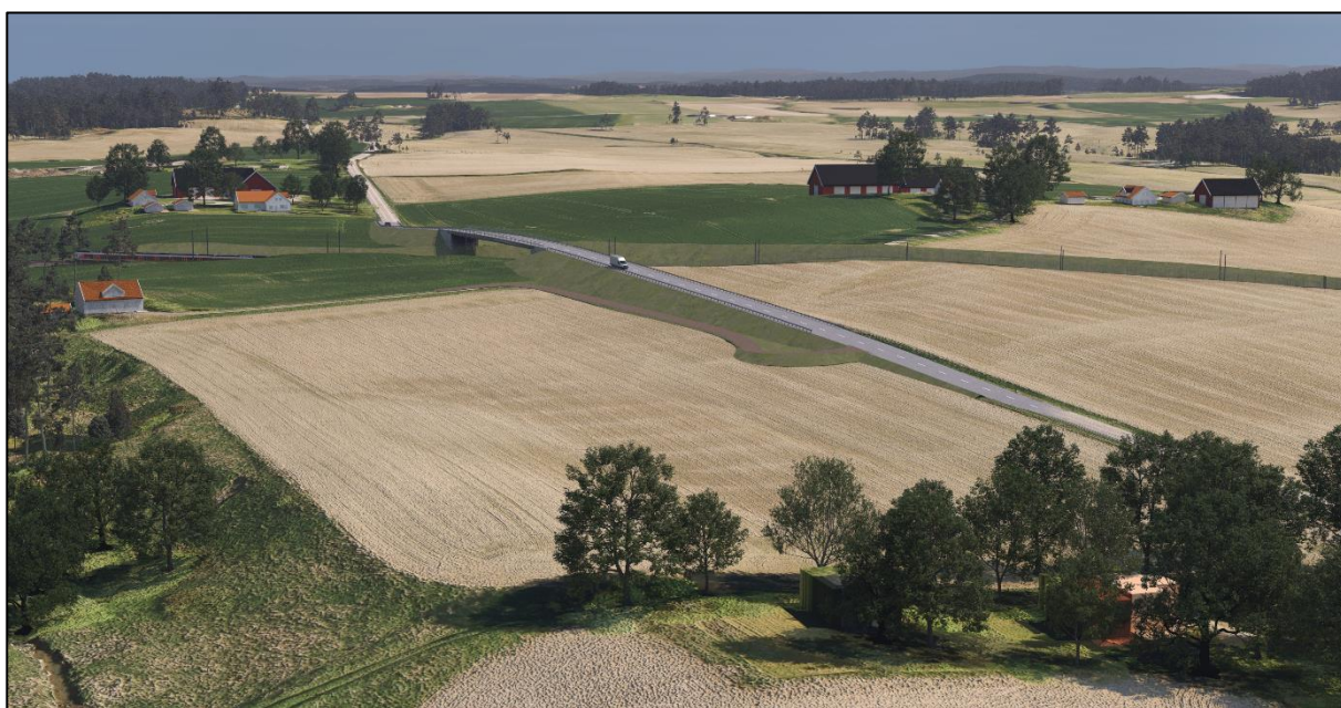
Figur 6-9: Alternativ L1 - Illustrasjon av tiltaket, sett i fugleperspektiv mot nord. Ny avgrening Østre linje krysser under Løkenveien (fv. 1370), som legges i bru over jernbanen. Linjen er senket i forhold til L0. Bru for Løkenveien er tilsvarende lavere, og veifyllinger blir vesentlig mindre. Endret atkomst til Løkenveien 30 blir kortere enn i L0-alternativet. Ny atkomst til Vang gård blir tilsvarende som i alt. L0.
