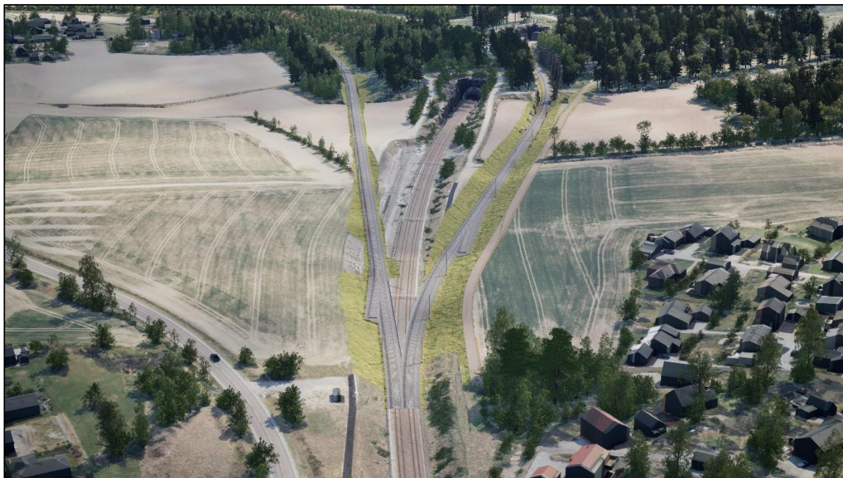
Figur 6-3: Oversiktsillustrasjon/fugleperspektiv, sett mot sør (i retning fra Ski). Ny avgrening Østre linje skiller lag med Vestre linje i et sørgående spor (til høyre i illustrasjonen) og et nordgående spor (til venstre i illustrasjonen). Sørgående spor krysser Vestre linje planskilt og kommer sammen med det nordgående sporet like vest for Åsveien, hvor de to sporene samles til et dobbeltspor i retning østover. Bebyggelse i Follogrenda/Folloveien ses nederst til høyre.
