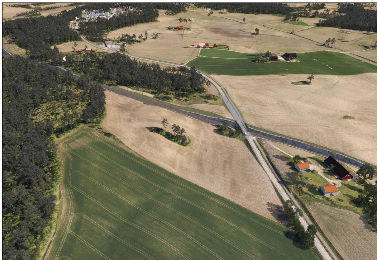
Figur 6-7: Alternativ L1 - Illustrasjon av tiltaket ved Kråkstadveien (fv. 1368), sett i fugleperspektiv mot nord. Ny avgrening Østre linje krysser under Kråkstadveien, som legges på bru over jernbanen. Det er nærføring til Nordre Frogner gård (til høyre). I alternativ L1 er veibrua for Kråkstadveien nært terrengnivå, som gir mindre veifyllinger inn mot brua.
