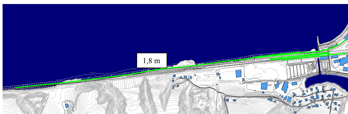
Figur 3: Støyskjerm i sør (km 67,0 – 69,5), øst for sporet, 1,8 meter over SOK.
