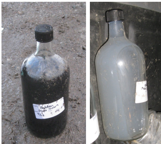
Figur 3: Prøver av lensevann ved sedimentasjonsbassenget, hhv rett etter prøvetaking og neste dag
