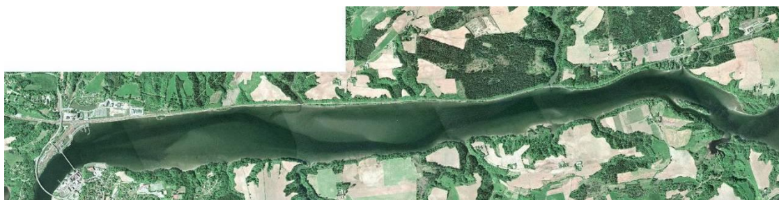
Figur 1. Flybilde som viser utbredelse av mudderbanker og hovedløpet for Vorma fra Eidsvoll (venstre billedkant) til Kråkvål sør av Minnesund.
