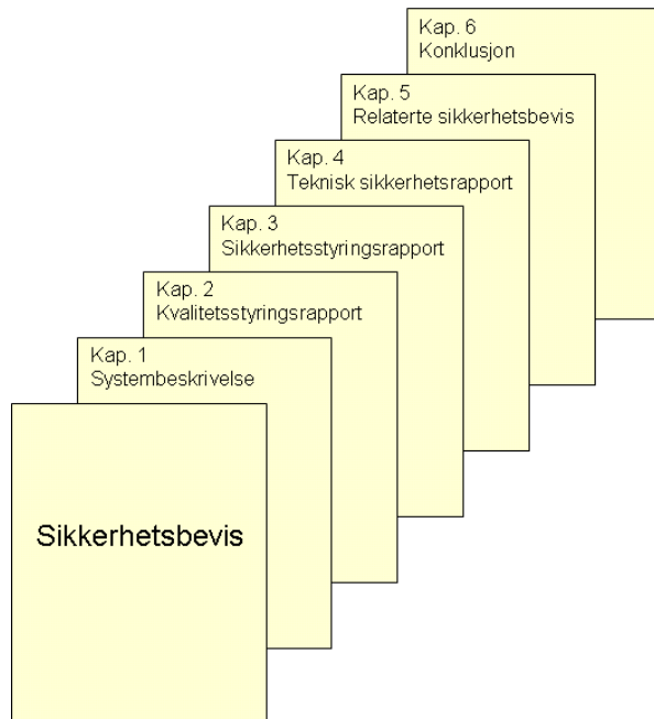
Figur 3 Oppbygning av sikkerhetsbevis i henhold til EN 50129
